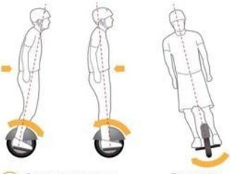
⚙️ Для движения наклоняем корпус вперед и надавливаем передней частью ступни на подножку. При переносе веса с носка на пятку и отклонении корпуса назад происходит торможение и далее движение назад.
