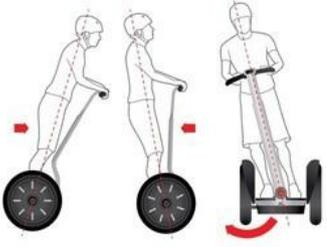
⚙️ Чтобы начать движение, следует наклонить корпус вперед – и чем сильнее, тем выше будет скорость. При отведении корпуса назад, движение будет замедляться, произойдет остановка или включится задний ход.
